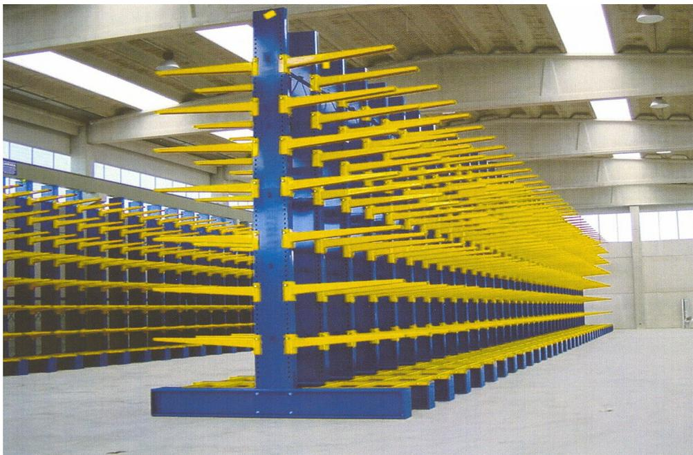
Scaffalatura autoportante particolarmente adatta per lo stoccaggio di materiali lunghi quali tubi, barre, profilati, lamiere in pacchi, coils, legnami e truciolari in genere. Disponibile in due versioni di diverse portate, permette la realizzazione di magazzini dimensionati per esigenze specifiche. Verniciatura a forno con polveri epossidiche.
