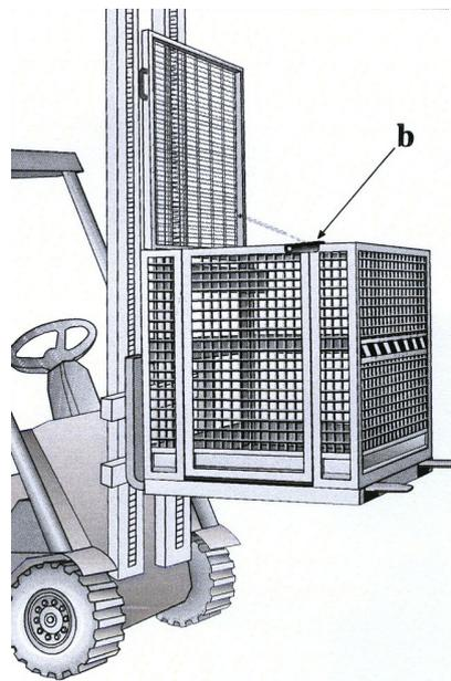
14 Dispositivo di bloccaggio della porta.
