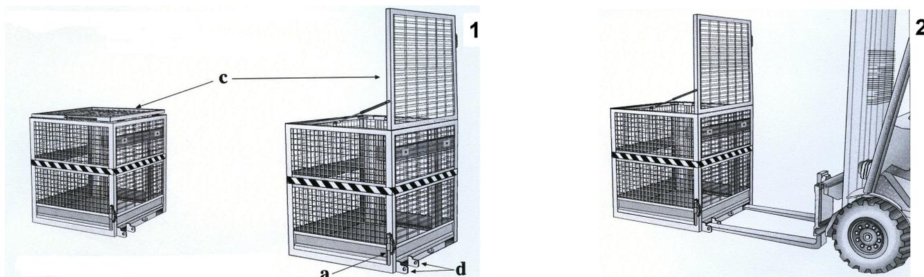
Mettere in posizione verticale la rete di protezione (c) e fissarla con le viti in dotazione. Dispositivo di bloccaggio: Piatti (d) - Perno (a)
