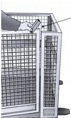
13 Dispositivo di bloccaggio della porta.
