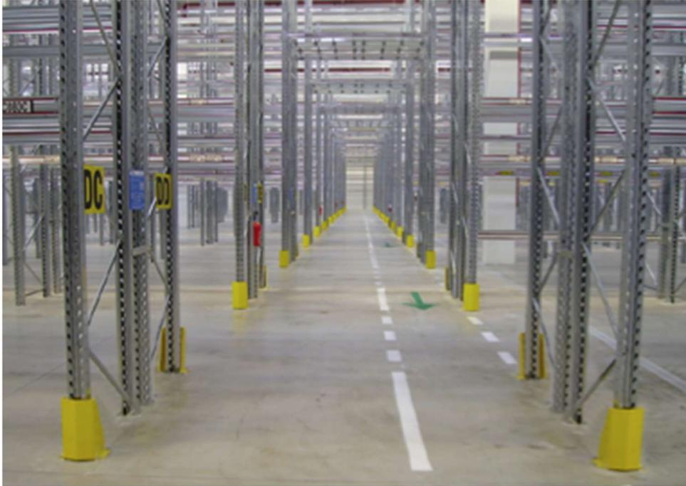
Scaffalatura interamente realizzata in lamiera di acciaio di prima scelta certificata e profilata a freddo con acciaio zincato a caldo secondo procedimento SENDZIMIR (ad eccezione delle basette che sono protette con zincatura elettrolitica). Disponibili in due versioni di diverse portate. Verniciatura a forno con polveri epossidiche. La progettazione e la costruzione sono state effettuate secondo norme UNI e hanno superato i collaudi al massimo livello. Le norme di riferimento sono:
