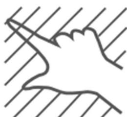
A DISTANZA DI SICUREZZA MINIMA  $\geq 200$  mm per aperture quadrate di lato compreso tra 30 e 40 mm
