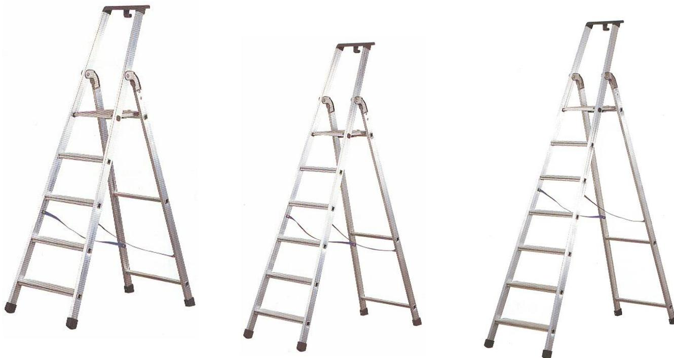
Realizzate interamente in alluminio anodizzato con montanti sezione mm.24x50. Gradini antisdrucciolevoli sezione mm.85 bloccati direttamente ai montanti. Dotate di vaschetta porta attrezzi in plastica nera e pianerottolo autobloccante di mm.260x270 di profondità. Le scale da 5 a 8 gradini sono dotate di 2 nastri di tenuta.
