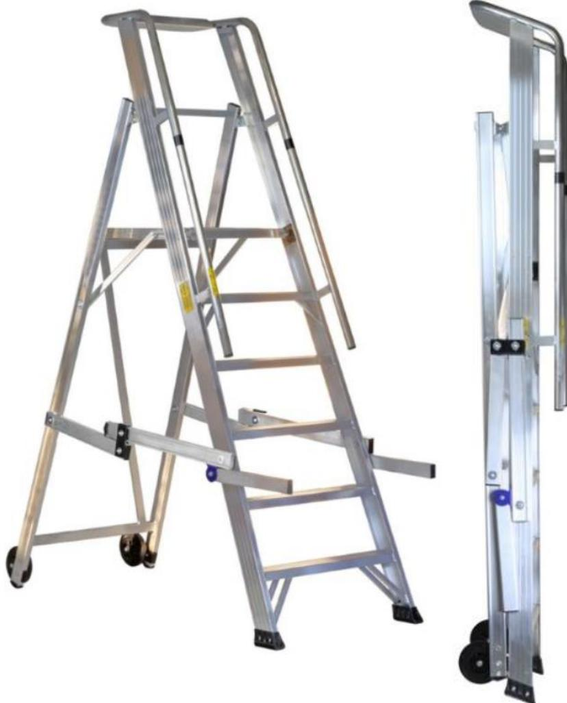
Costruite in alluminio estruso nervato, 2 ruote posteriori diam.mm.150 in pvc, gradini antisdrucchiolo saldati ai montanti di mm.80 con passo da mm. 250, 2 corrimano con guarda-corpo-h.mm.800.
